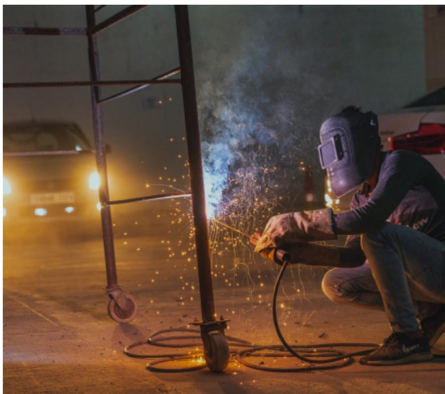
**Режим ММА** – Для работы со штучными электродами с различным видом покрытия: кислым, основным, рутиловым.
