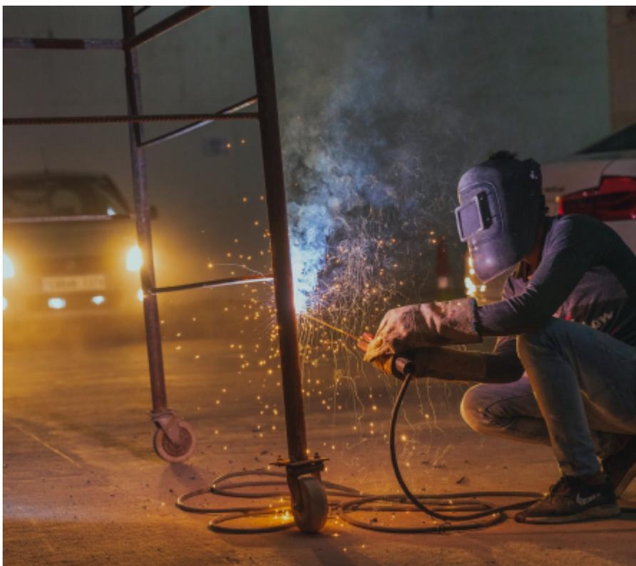
**Режим MMA** – Для работы со штучными электродами с различным видом покрытия: кислым, основным, рутиловым.
