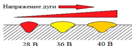
С увеличением напряжения дуги увеличивается ширина сварного шва (валика). Повышенное сварочное напряжение приводит к перегреву сварочной ванны и снижению механических свойств шва за счет эффекта самоотпуска и некорректной кристаллизации.
