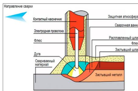
Дуговая сварка под флюсом позволяет:
