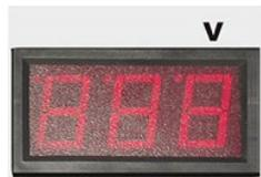
**ЦИФРОВОЙ ДИСПЛЕЙ, ПОКАЗЫВАЕТ УСТАНОВЛЕННОЕ СВАРОЧНОЕ НАПРЯЖЕНИЕ В РЕЖИМЕ ПОЛУАВТОМАТИЧЕСКОЙ СВАРКИ.**
