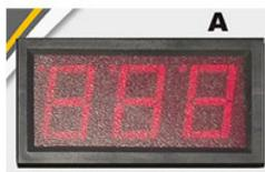
**ЦИФРОВОЙ ДИСПЛЕЙ, ПОКАЗЫВАЕТ УСТАНОВЛЕННЫЙ СВАРОЧНЫЙ ТОК В РЕЖИМЕ ММА И TIG СКОРОСТЬ ПОДАЧИ ПРОВОЛОКИ В РЕЖИМЕ MIG/MAG**
