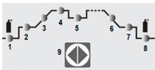
ДЛЯ КАЖДОГО МЕТОДА И РЕЖИМА СВАРКИ ВОЗМОЖНО УСТАНАВЛИВАТЬ РАЗЛИЧНЫЕ ДОПОЛНИТЕЛЬНЫЕ НАСТРОЙКИ НА КАЖДОМ ЭТАПЕ СВАРКИ.
