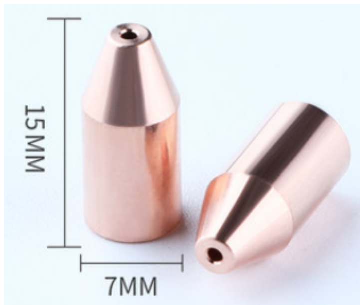
СОПЛО-НАКОНЕЧНИК ПОД ПРОВОЛОКУ ДЛЯ ЛАЗЕРНОЙ СВАРКИ НАПРАВЛЯЮЩЕЕ M5*L15*0,8 / WIRE GUIDE NOZZLE (2070)
